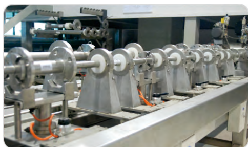
管路設備I (在小管徑時，可同時測4台)
