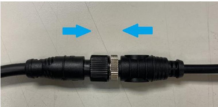
依第 6.3 章節完成配線且將 JTR 短量程導波雷達安裝完成後，將電纜線快速接頭依箭頭方向連結插入即完成電路安裝。
