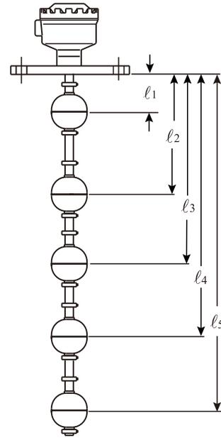
※  $\overset{\text{NO}}{\square} \overset{\text{C}}{\checkmark} \overset{\text{NC}}{\checkmark}$  表示液位低於浮球時接點接通；NC 或 B 或 ON ↓
