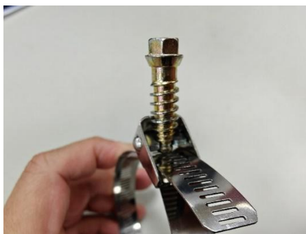
步驟二：由鎖固螺絲下方穿出金屬管束
