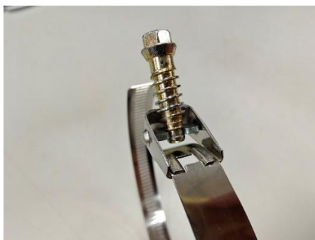
步驟一：將鎖固螺絲拉起如圖
