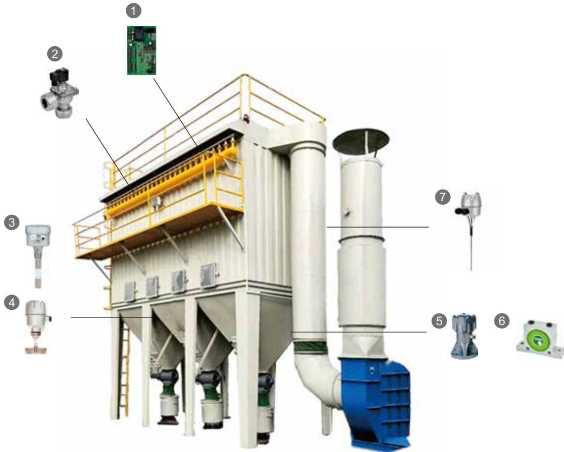
集塵設備可以參考上圖的作整體規劃，順序控制器用來控制膜片閥逆洗集塵布袋管，可以延長使用壽命，粉塵濃度計可以探測煙囪的粉塵濃度測量，它的訊號也可以連結到順序控制器，當輸出訊號高於設定值，表示布袋較大程度的附著，自動縮短噴氣間隔時間提高清袋的效率，另外在集塵設備斜斗槽加裝空氣鏈或振動器，可以避免物料架橋情形。裝設了阻旋式葉片開關或靜電容料位開關，都是可以作為集塵桶槽高/低料位警報的控制感應器。
