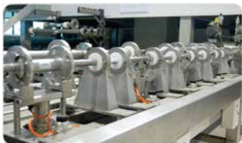
管路設備I (在小管徑時，可同時測4台)
